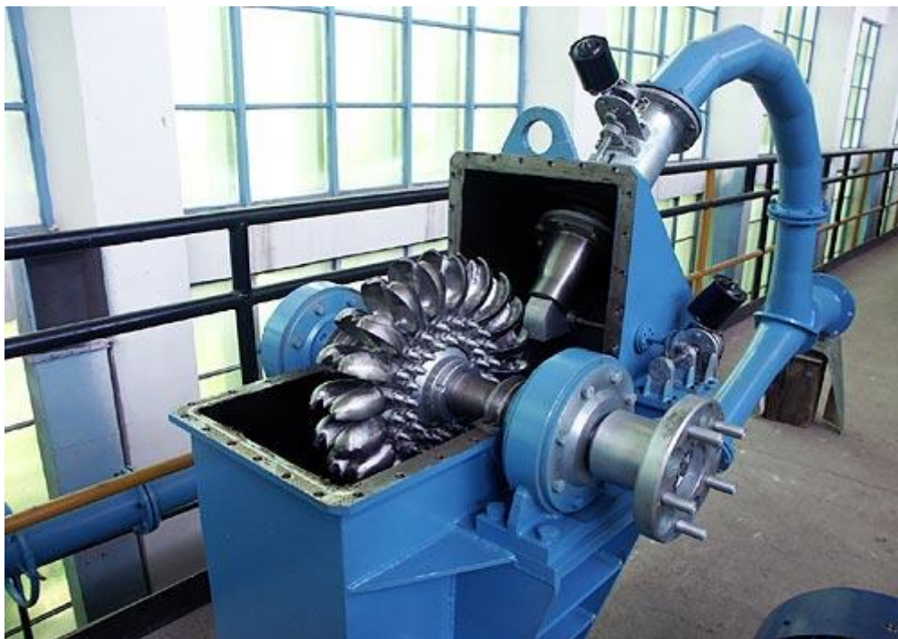
Figure III.4 Turbine à deux injecteurs [18]
