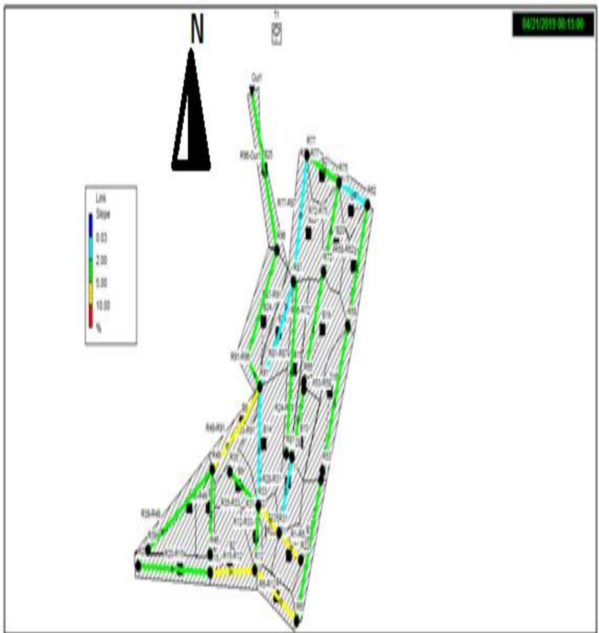
Figure IV.15 : Pentes supérieures à 5% ; (Steady flow)
