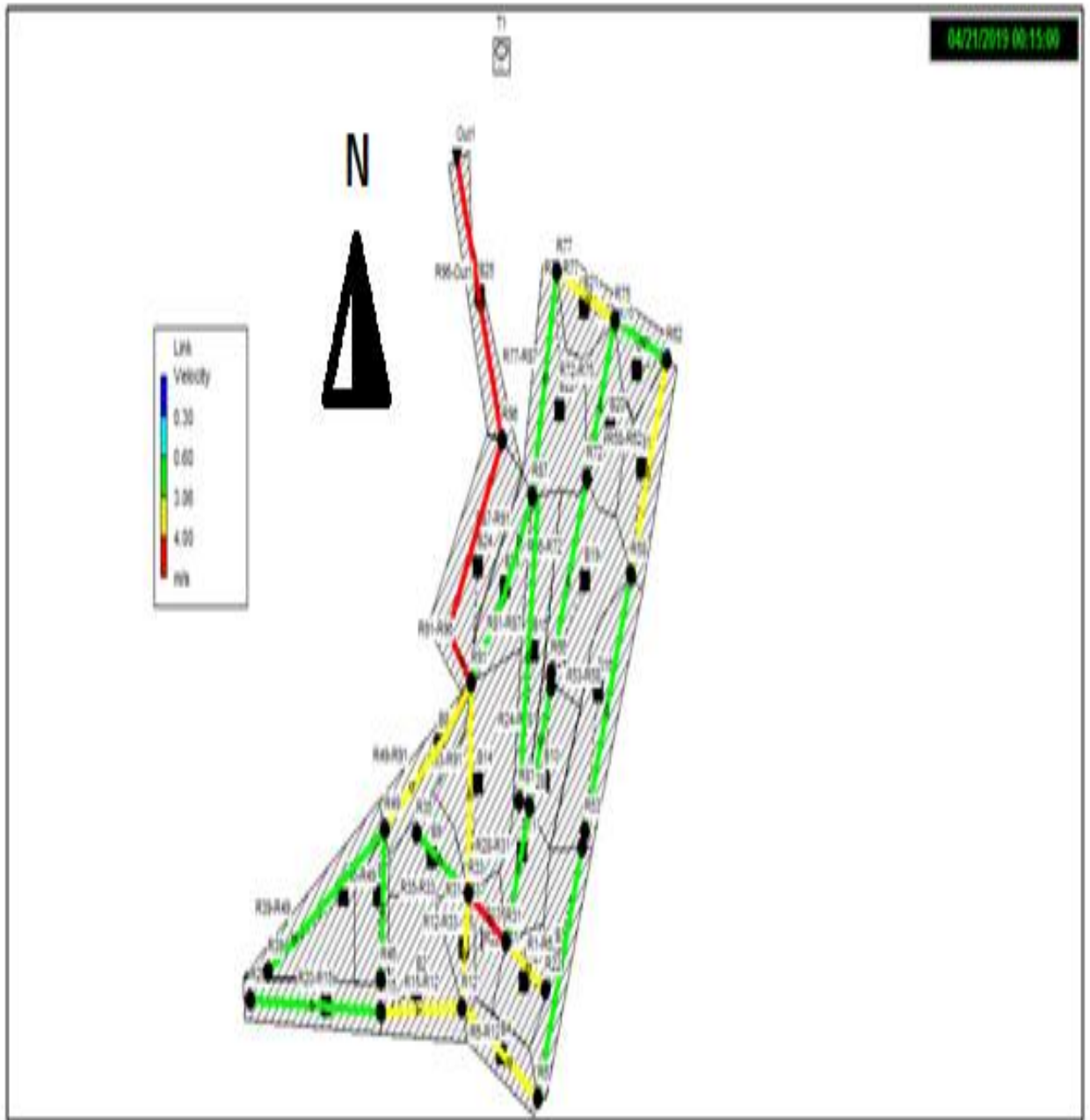
Figure IV.16 : vitesses supérieures à 3,05 m/s ; (Steady flow)
