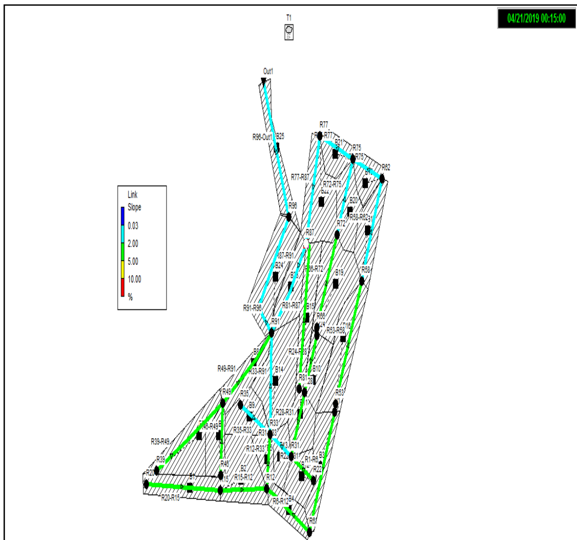
Figure IV.34 : Pentes de la simulation finale
