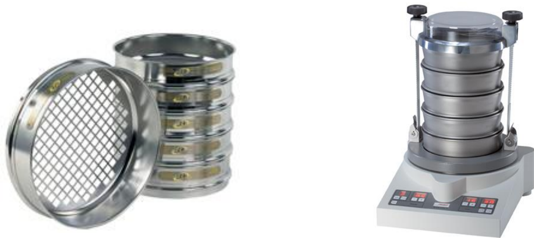
Figure 4.9 Analyse granulométrique par tamisage [42].
