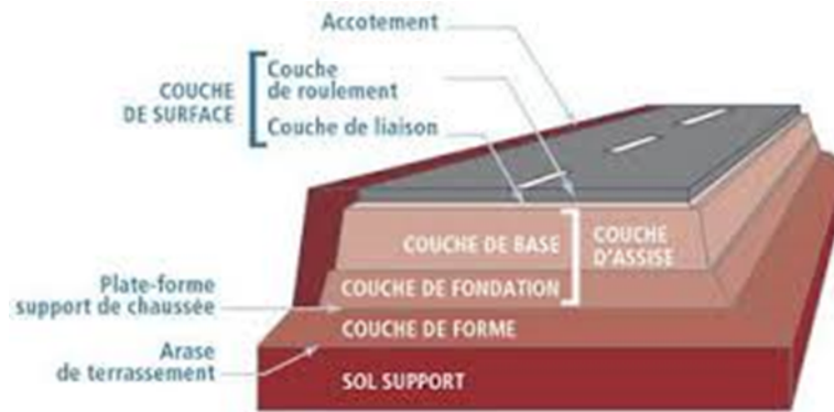
Figure 3.1 : Corps de chaussée et ces différentes couches.
