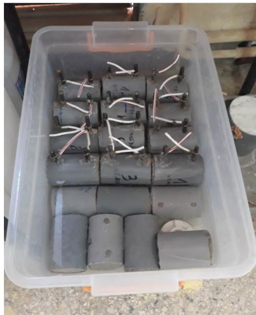
Figure III.12 : La cure des éprouvettes dans un bac d'eau.
