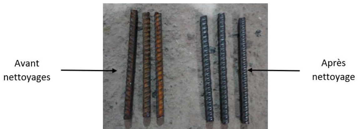
Figure III.3 : Nettoyage des barres d'armatures.
