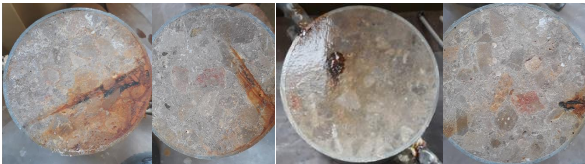
Figure IV.14 : Trace de corrosion sur la surface des différents échantillons de béton
