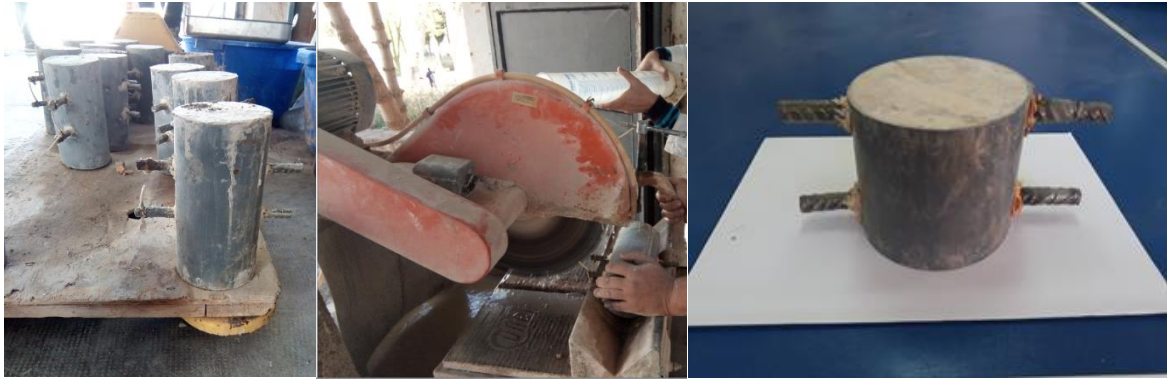
Figure III.8 : Découpage des éprouvettes de béton.
