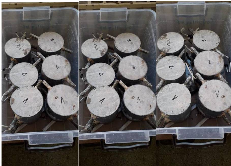
Figure III.14 : Disposition des éprouvettes de béton dans des bacs à 30g/l, 120g/l et 240g/l de NaCl pour la partie de mouillage.
