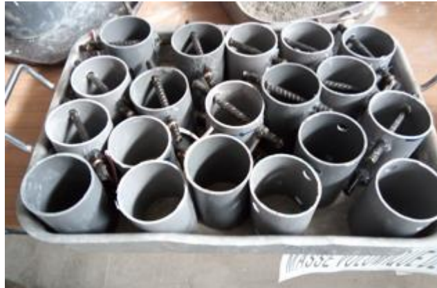
Figure III.10 : Insertion des barres d'armatures dans les moules de mortier.
