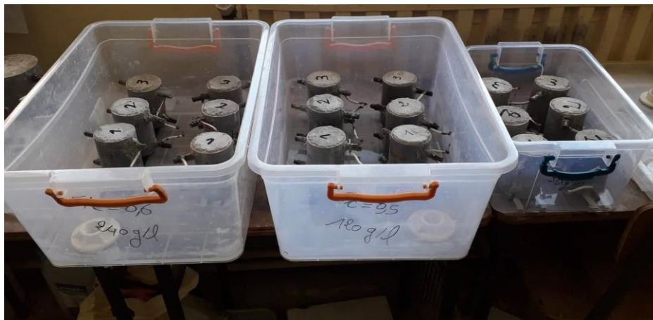
Figure III.16 : Disposition des éprouvettes de mortier dans des bacs à 30g/l, 120g/l et 240g/l de NaCl pour la partie de mouillage.
