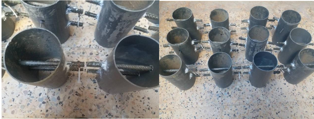
Figure III.7 : Insertion des d'armatures dans les moules de béton.
