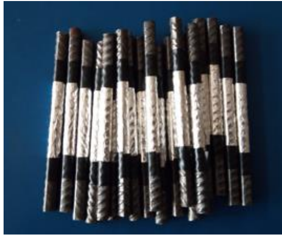
Figure III.4 : Conservation des parties centrales des barres d'armatures avec de papier d'aluminium.
