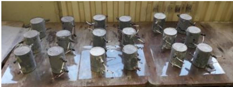
Figure III.18 : Disposition des éprouvettes de mortier au séchage.
