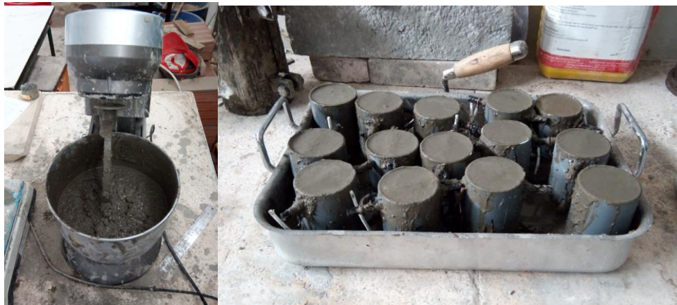
Figure III.11 : Malaxage de mortier et remplissage des éprouvettes.
