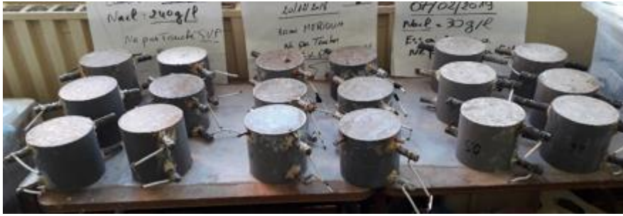
Figure III.17 : Disposition des éprouvettes de béton au séchage.
