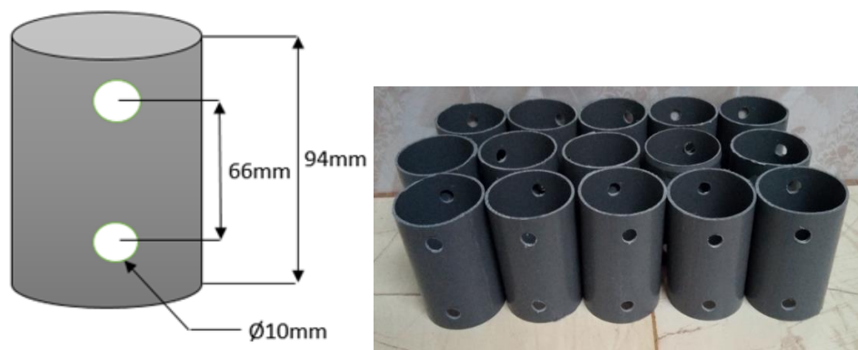
Figure III.9 : Moule de mortier pour essai de corrosion.
