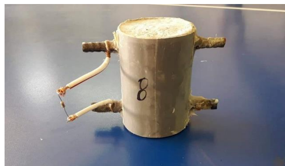
Figure III.19 : Résistance électrique de 100 Ohm connectée au fils électriques
