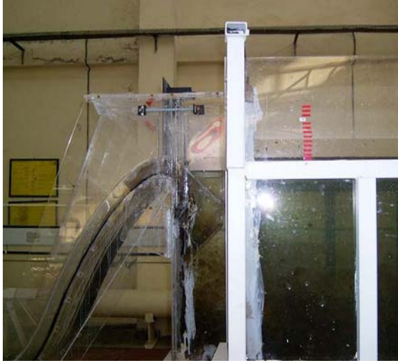
Photos III.05 : Evacuateurs de crues en siphon [19]
