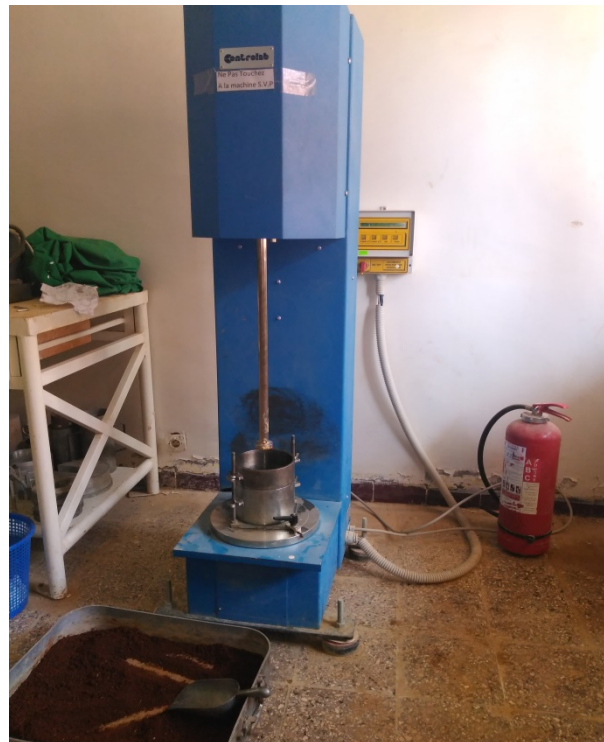
Figure 22 : Appareil de compactage
