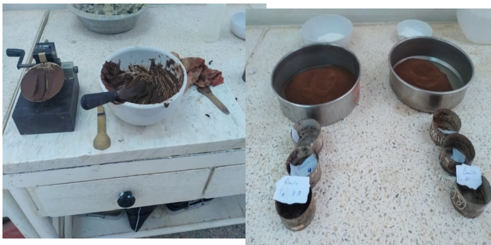
Figure 16 : Préparation des échantillons pour déterminer la limite de liquidité
