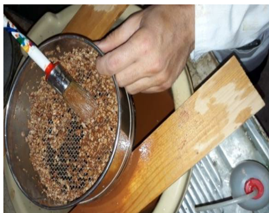
Photo III.4 : Tamisage par voie humide du sédiment Oued Taht.
