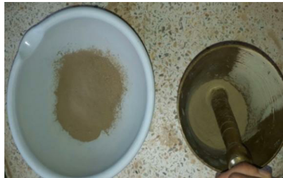
Photo III.6 : Homogénéisation du matériau(le fond) après séchage à l'étuve.
