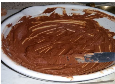
Photo III.9 : Essai de Casa grande pour la détermination de la limite de liquidité ( w_L ) du sédiment Oued Taht.
