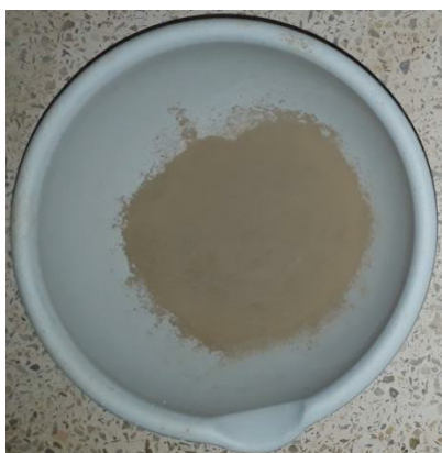
Photo III.13: Mesure de la teneur en MO du sédiment Oued Taht par calcination dans un four à moufle à 450°C.
