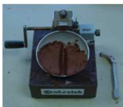
Photo III.9 : Essai de Casa grande pour la détermination de la limite de liquidité ( w_L ) du sédiment Oued Taht.
