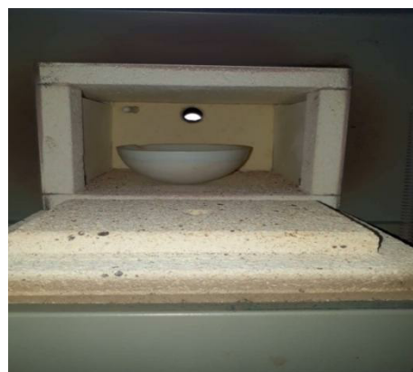
Photo III.13: Mesure de la teneur en MO du sédiment Oued Taht par calcination dans un four à moufle à 450°C.
