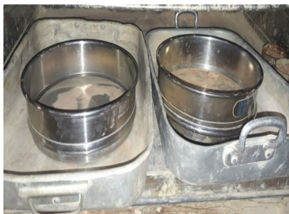
Photo III.4 : Tamisage par voie humide du sédiment Oued Taht.
