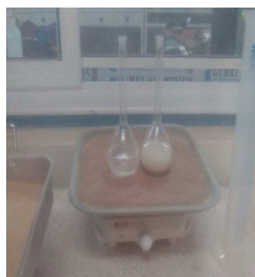
Photo III.15 : Détermination du poids volumique des grains solides pour le sédiment Oued Taht.
