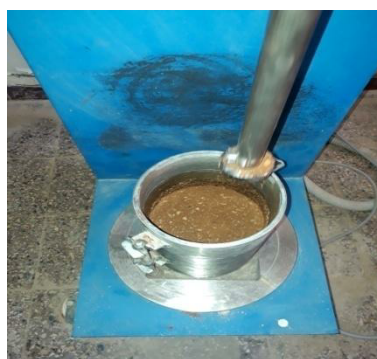
Photo III.16 : Détermination des paramètres de compactage pour le sédiment Oued Taht.
