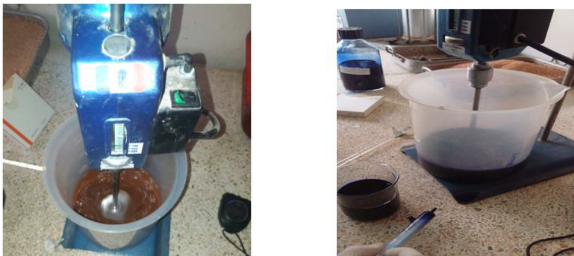
Photo III.12 : Essai au bleu de méthylène sur le sédiment Oued Taht.
