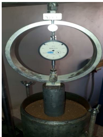
Photo III.17 : Détermination de l'indice IPI pour le sédiment Oued Taht.
