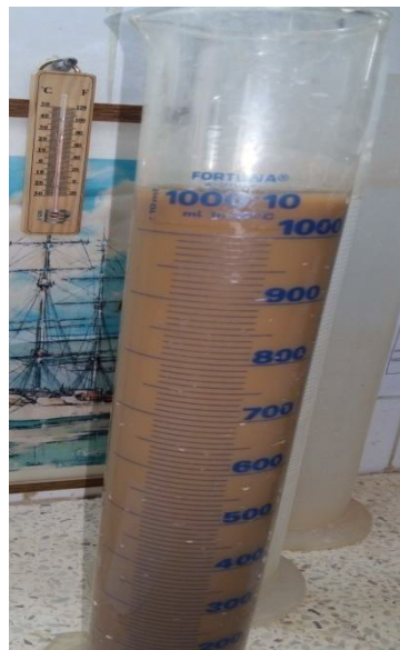
Photo III.8 : Décantation des particules du sédiment Oued Taht lors de l'essai de sédimentométrie.
