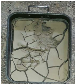
Photo III.6 : Homogénéisation du matériau(le fond) après séchage à l'étuve.
