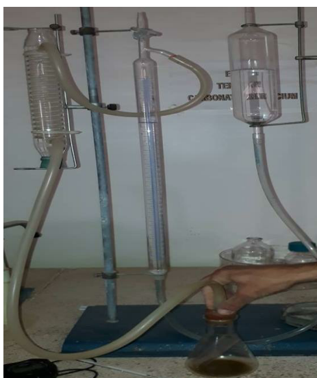
Photo III.14 : Détermination de la teneur en carbonate ( \text{CaCO}_3 ) pour le sédiment Oued Taht par l'essai au Calcimètre.
