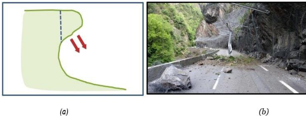
Figure 1.10 – (a) Schématisation du phénomène d'éboulement, (b) mai 2017, éboulement sur la RD921 dans les Hautes Pyrénées
