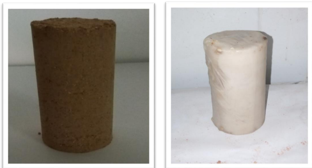
Figure 3.6 : compactage statique (éprouvettes obtenues 10x 5 cm x cm).
