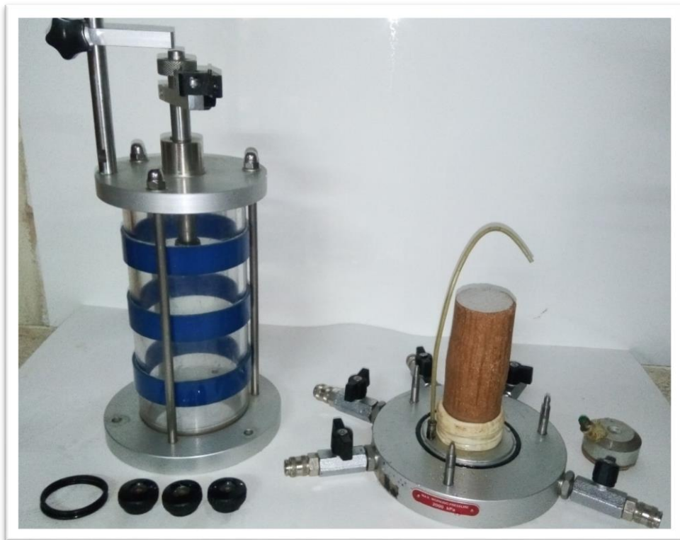
Figure 3.14: démontage de la cellule triaxial.
