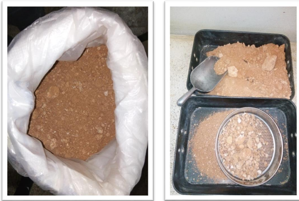
Figure3.3: Mode opératoire compactage statique (étape de tamisage).
