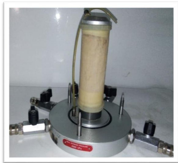
Figure 3.12 Montage de l'éprouvette dans cellule triaxiale
