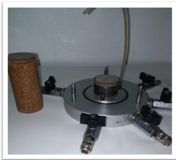
Figure 3.12 Montage de l'éprouvette dans cellule triaxiale
