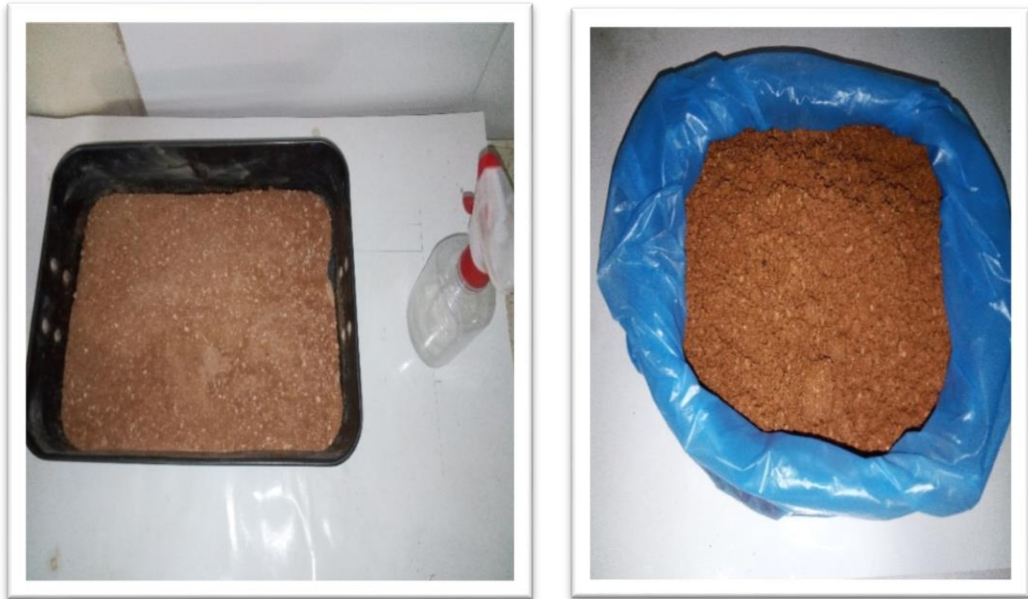
Figure 3.4 : mode opératoire compactage statique (étape de malaxage).
