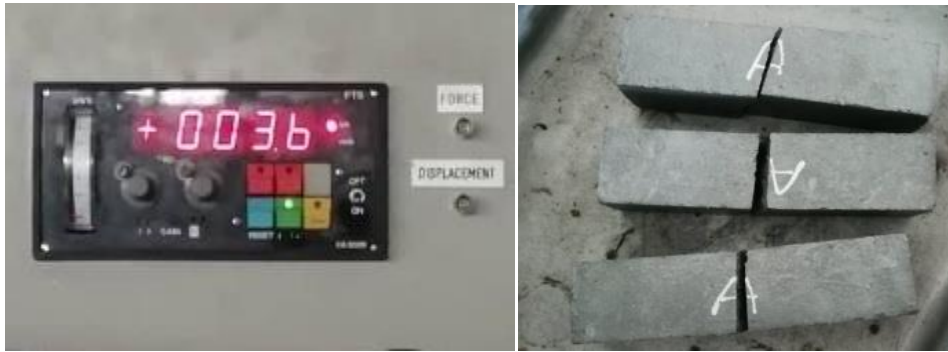
Figure 5.8: Etat des mortiers après rupture.
