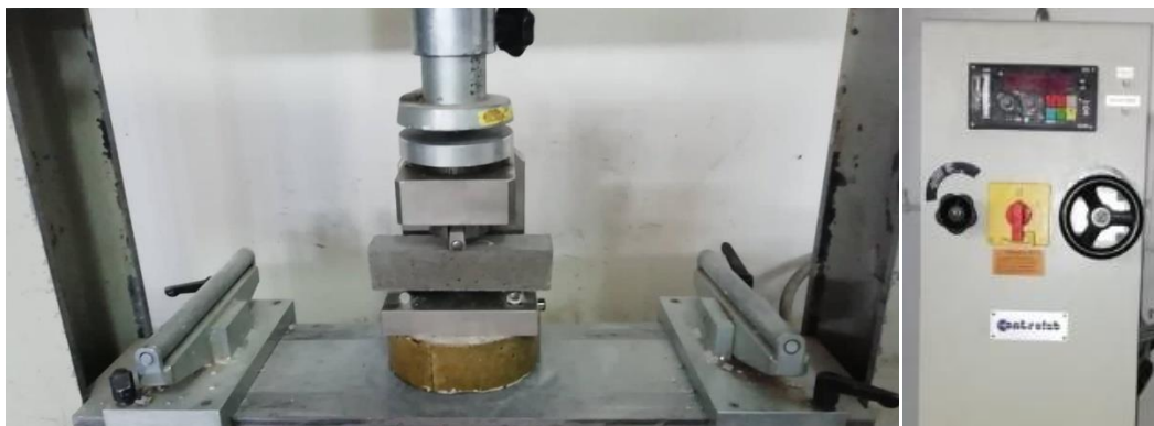
Figure 5.7: Dispositif de l'essai de traction par flexion
