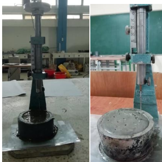
Figure 5.3: Essai de prise du ciment à l'aide de l'aiguille de Vicat.
