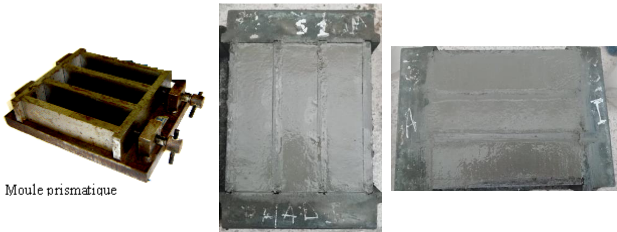
Figure 5.4: Mortiers introduits dans les moules prismatiques 4*4*16 après 24h.
