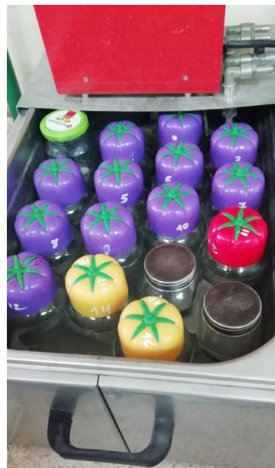
Figure 3.5: Mise en place des pièces dans les béchers, ensuite dans le bain thermostat
