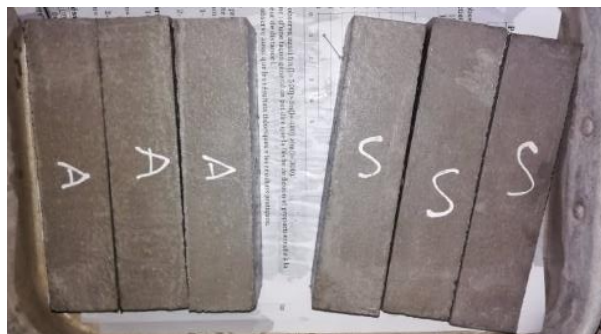
Figure 5.5: Mortiers destinés aux essais destructifs.
