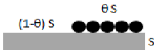
Figure 3.6: Schématisation du modèle de Langmuir.
