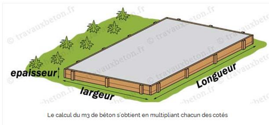
Figure III.5. : Béton pour dalle
