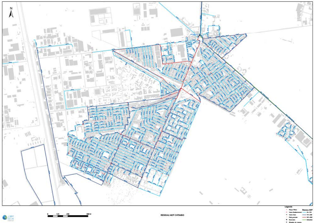
Figure II.6: Plan du réseau d'AEP de Chteibo avec configuration en réseaux primaire, secondaire et tertiaire.
