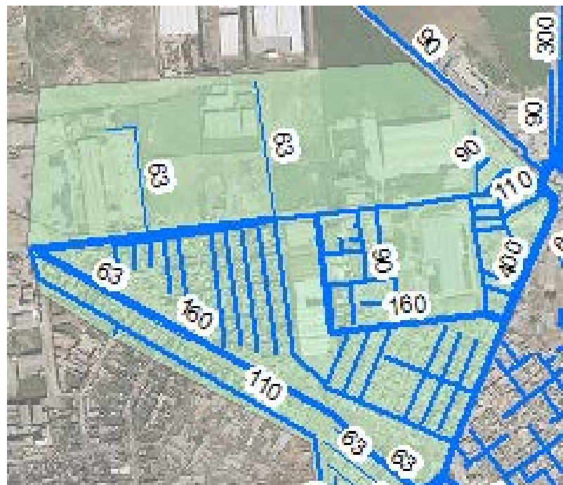
Figure III.19 : Réseau d'AEP du secteur 02
