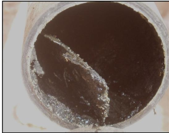
*Photo. 2 : Dépôts ligne 3 (Puits TFT 611).*
