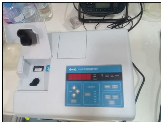
*Fig. 39: Turbidimètre.*
