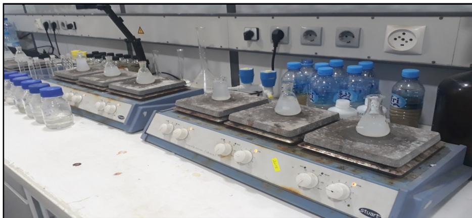
**Fig.65**: Teste d'efficacité du produit 'C' sur le mélange (TFT 36 / 223).
