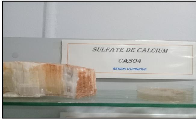
Fig. 22 : La forme cristalline du Sulfate de Calcium ( $\text{CaSO}_4$ ).
