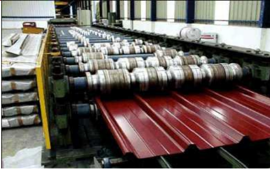
Figure 1.8.2 Le procédé de profilage
