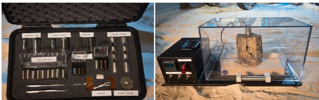
Figure I.14 : Les actuateurs brise roche( Benafan et noebe ,2015)
