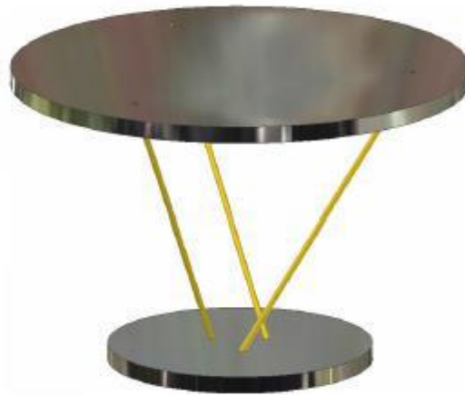
Figure I.16 : Dispositif d'isolement de base en AMF
