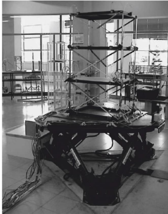
Figure II.1 : Prototype à armature en acier à petite échelle avec des entretoises en SMA (AMF) (adapté de Boroscheck et al., 2007).
