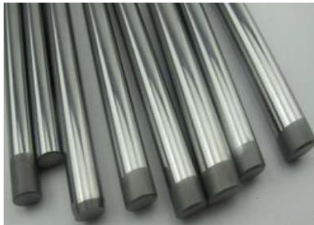
Figure I.8 : AMF à base de Ni-Ti
