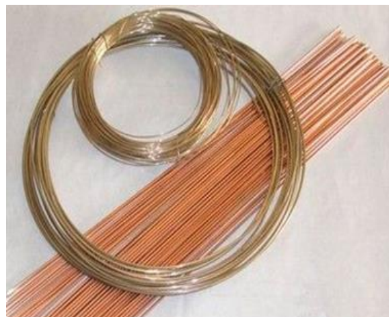
Figure I.10 : Barres et fils en AMF à base de Cuivre.
