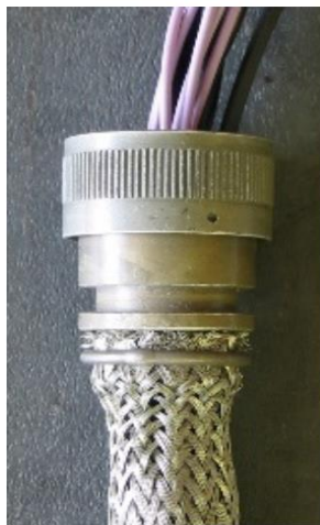
Figure I.13 : les connecteurs, la bague d'étanchéité ( https://www.intrinsicdevices.com/history.html )
