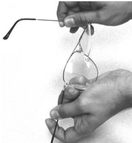
Figure I.11 : Applications pseudo-élastiques commerciales des AMF (Cadres de lunettes) (Melton, 1999)
