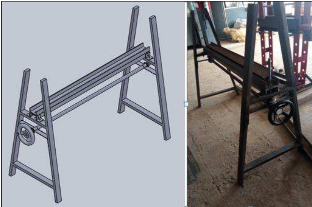
Fig.3.12. Montage cadre de la plieuse
