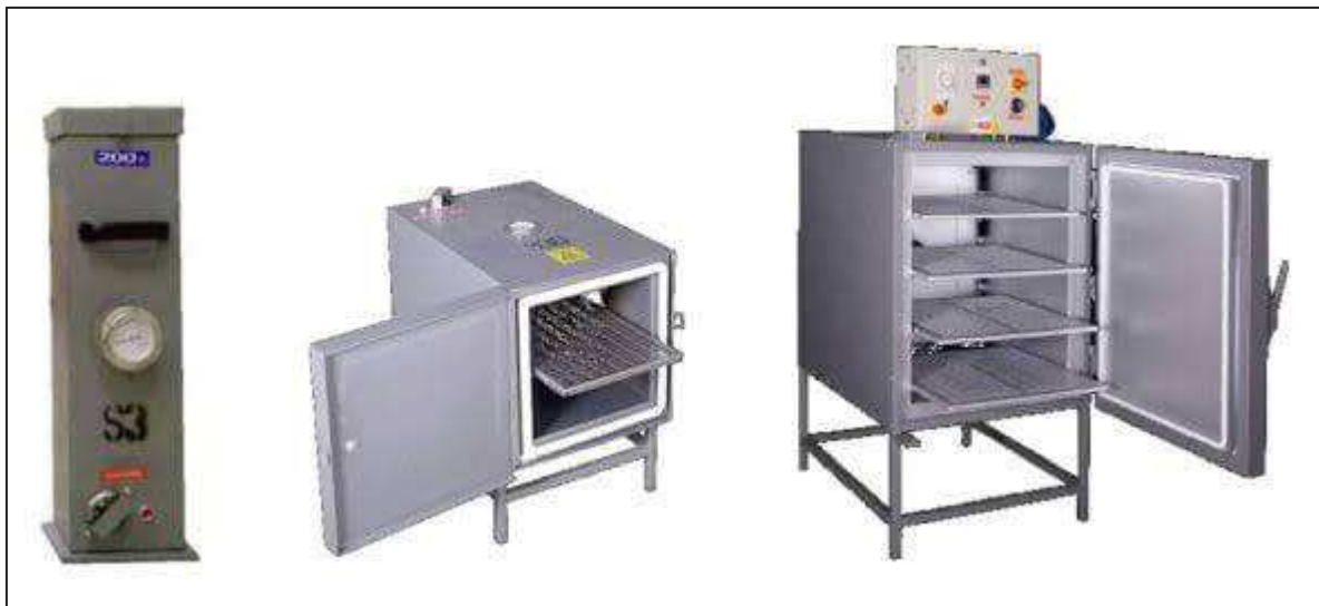
Fig1.15. Etuvages des électrodes enrobées [3]
