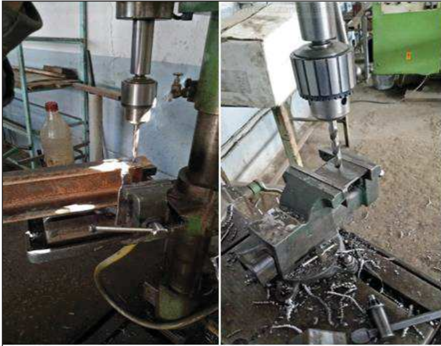
Fig.3.3. Perçage des poutrelles
