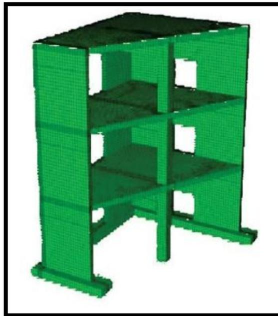
**Figure 1. 8 :** Discrétisation locale tridimensionnelle d'une structure – Projet Ecoleader -Structure Camus (8)
