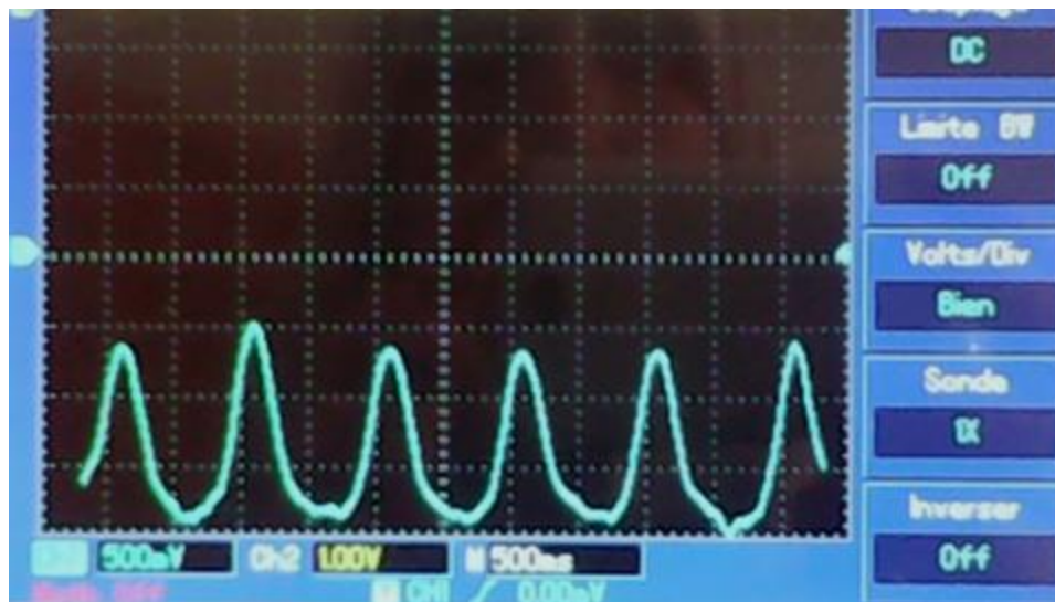
Figure III. 8: Signal du débit respiratoire amplifié d'un sujet de 24 ans
