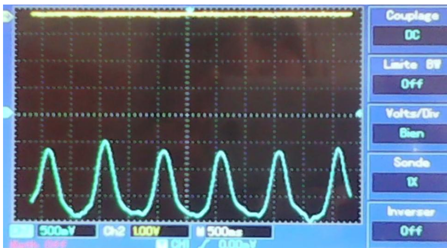
Figure II. 13: Le signal de sortie de l'étage d'amplification
