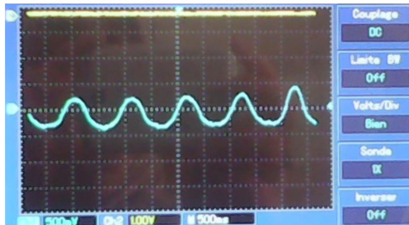
Figure II.9: Le signal de sortie de la pré-amplification
