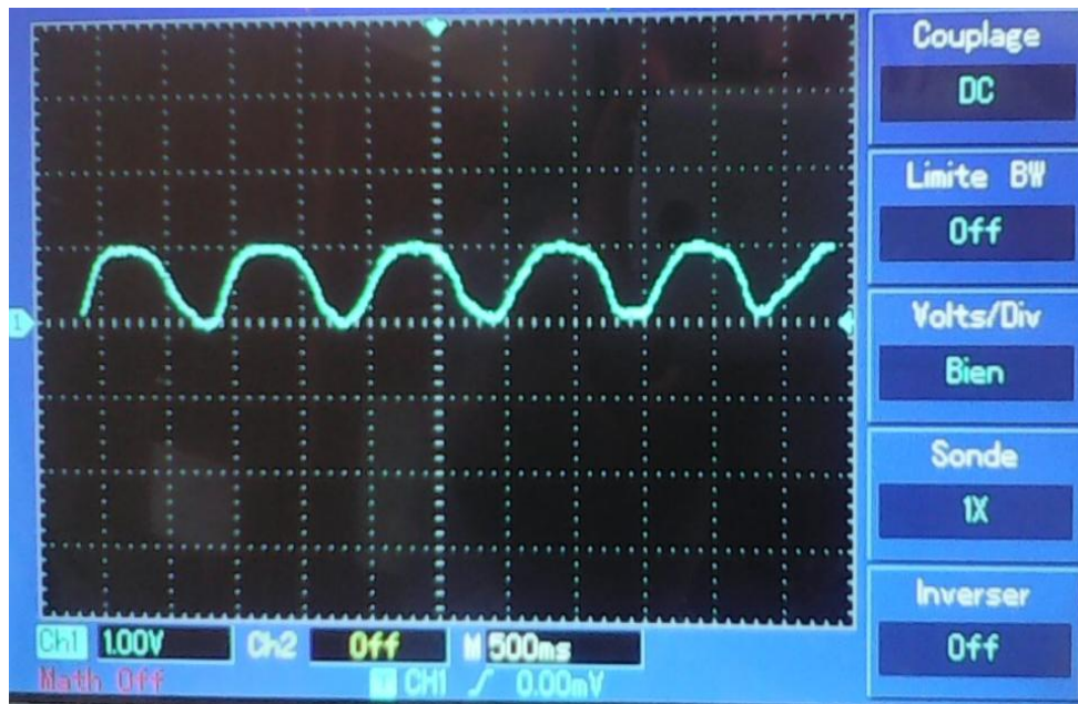
Figure III. 2: Signal du débit respiratoire d'un sujet de 25ans
