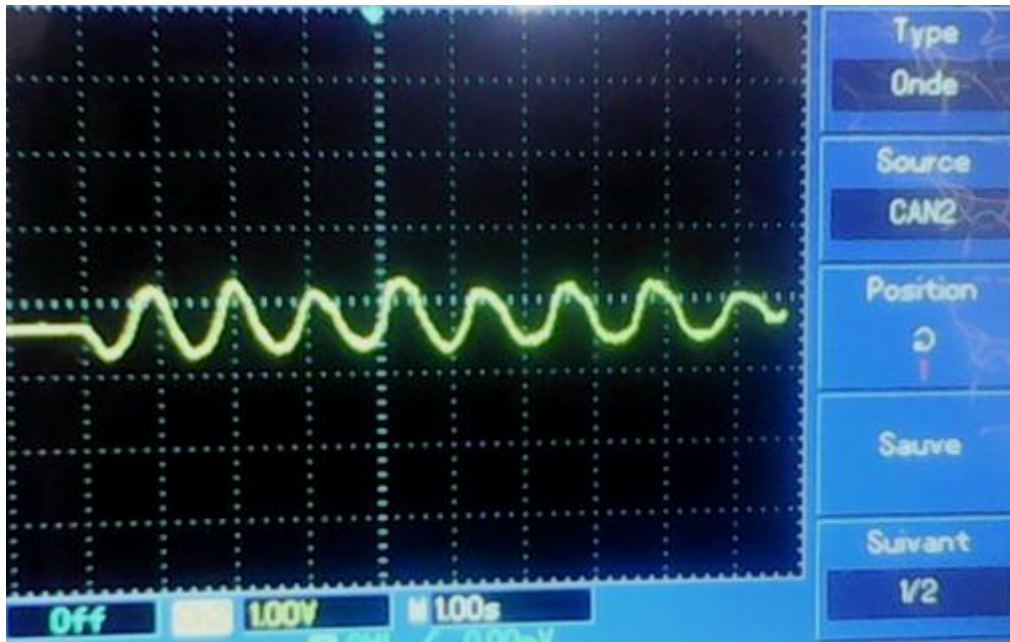
Figure III. 5: Signal de sortie du filtre d'un sujet de 23 ans
