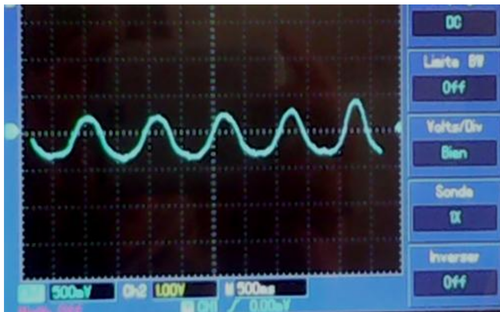
Figure III. 6: signal de sortie du filtre d'un sujet de 24 ans
