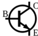
Figure 2.37 : Symbole d'un transistor.
