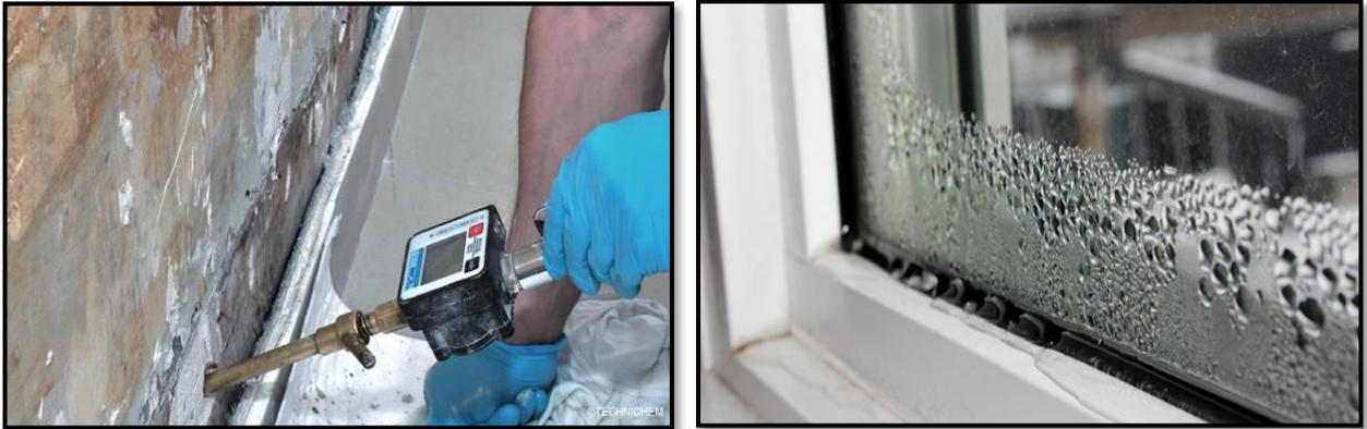
Figure 1.3 : Image d'un mesureur d'humidité.
