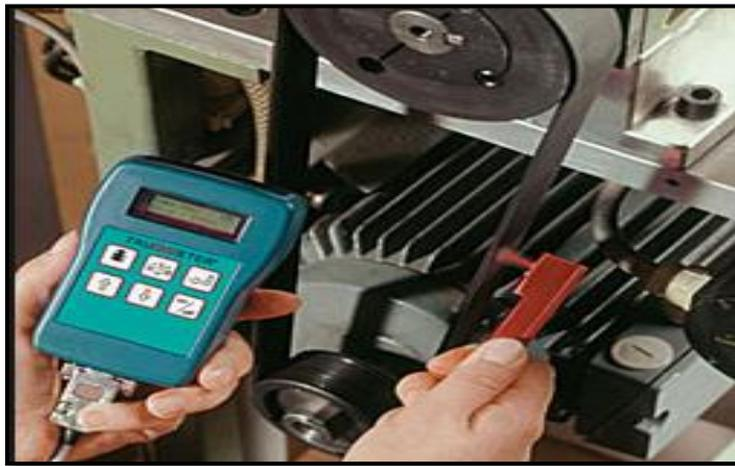
Figure1.8 : Photo d'un dynamomètre.
