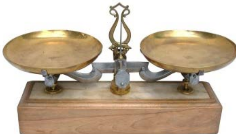
Figure1.9 : Grande balance de Roberval, de marque Frey & Studer à Strasbourg [1]
