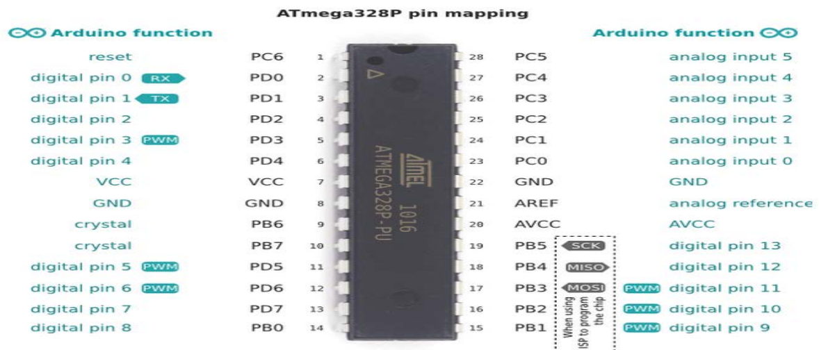
Figure3.5 : La correspondance entre les broches de l'ATMega328 et les broches de l'Arduino [17]
