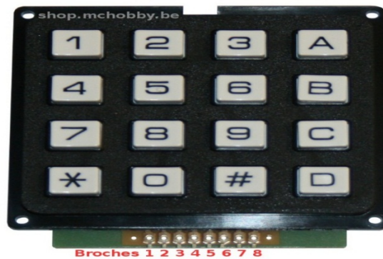
Figure 2.26 : Photo d'un clavier à 16 touches
