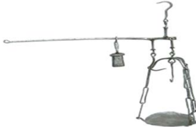
Figure1.2 : Romaine savoyarde ou piémontaise en fer forgé [1]
