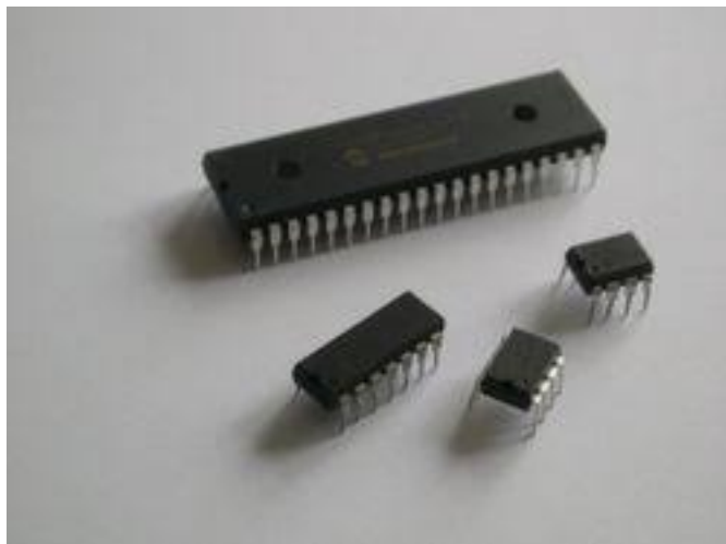
Figure1. 4: Quatre microcontrôleurs PIC de familles différentes
