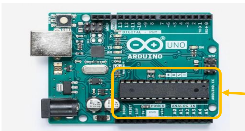
Figure 29 : Microcontrôleur ATmega328P de Arduino UNO.
