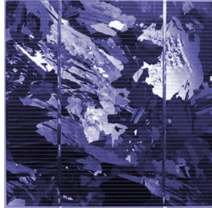
FIGURE I.7 – Exemple d'une cellule à silicium poly-cristallin
