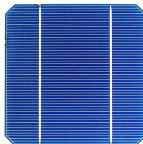
FIGURE I.6 – Exemple d'une cellule à silicium mono-cristalline
