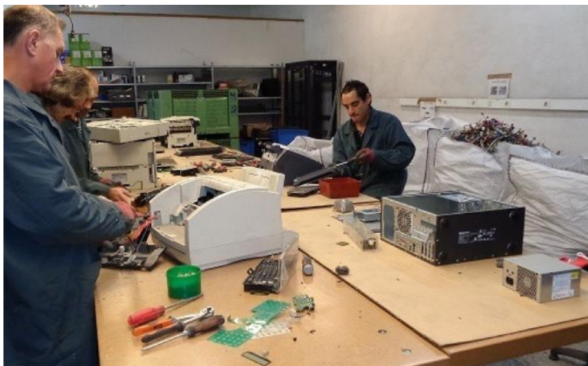
Figure IV.16 : Démantèlement des ordinateurs par des opérateurs au poste de travail.
