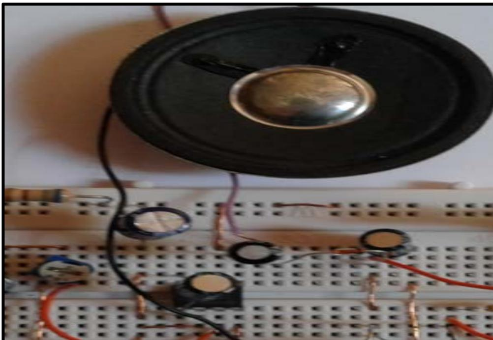
**Image III-3:** Réalisation d'étage amplificateur sous plaque d'essai
