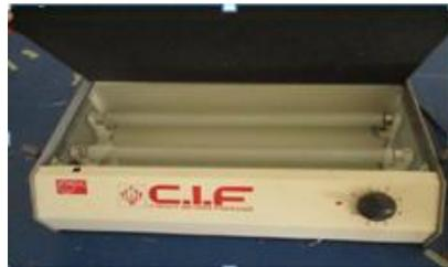
Figure 4.14 : Présentation de l'équipement permettant l'insolation.
