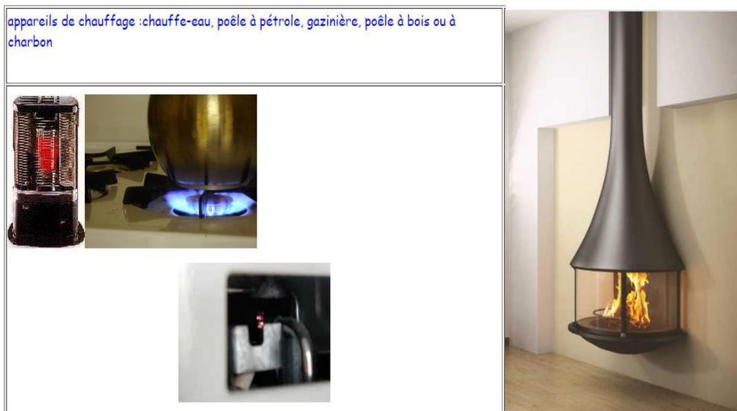
Figures 1.6 : Appareils domestiques susceptibles de dégager du monoxyde de carbone faute d'entretien.
