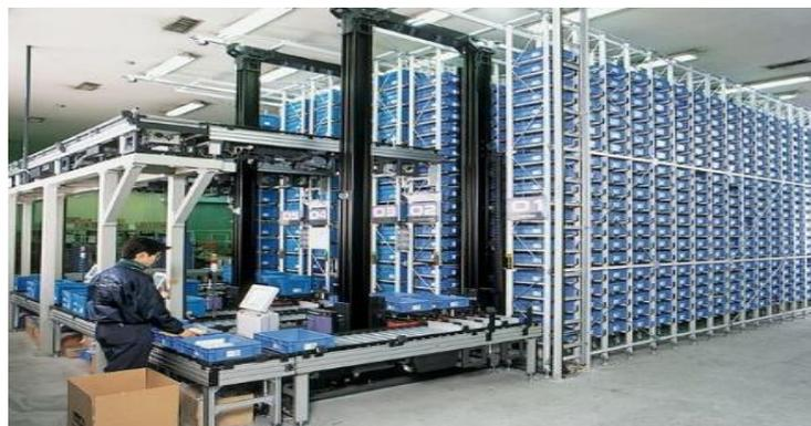
**Figure1.3 : AS/RS à mini charge**
