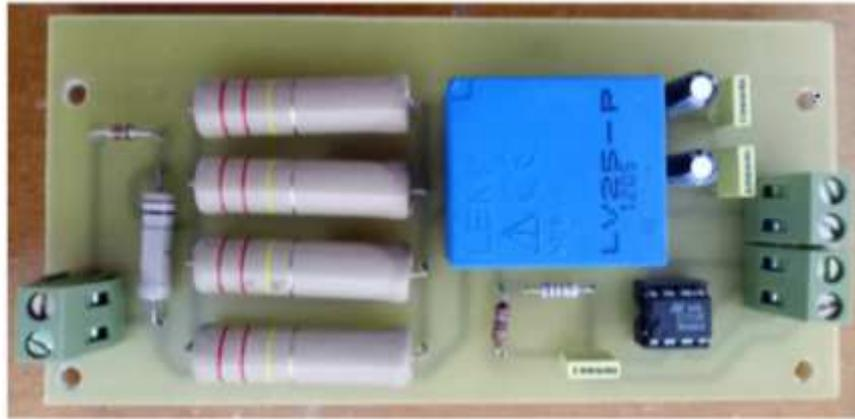
Figure 2.7 : Circuit électronique de capteur de tension LV25-p.[09]
