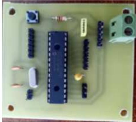
Figure 2.12 : Carte de commande basée sur le microcontrôleur dsPIC33Fj128GP802.[09]
