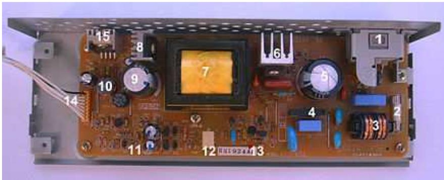
Figure 2.5 : Éléments principaux d'une alimentation à découpage.[10]
