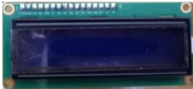
Figure 2.11 : Afficheur LCD alphanumérique 2×16.
