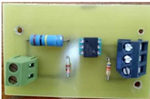
Figure 2.13 : Circuit électronique de détecteur de passage par zéros.[09]
