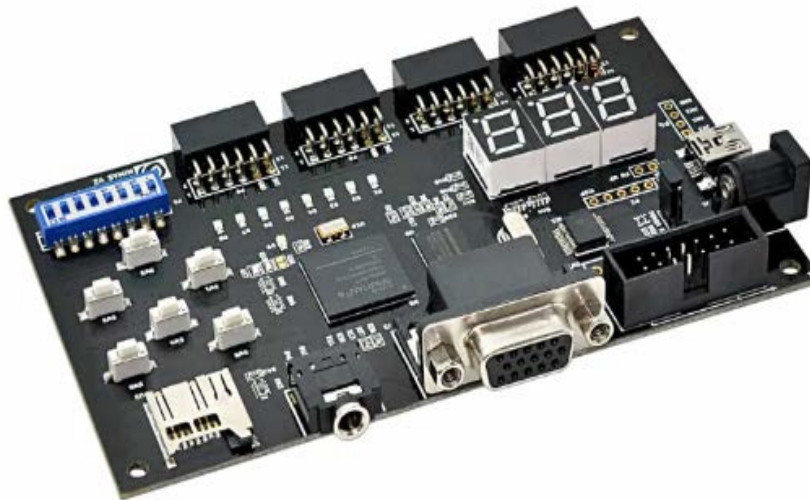
Figure III.24. La carte de développement MIMAS V2
