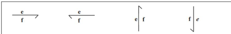
FIGURE 2.5 – Le sens de transmission de la puissance
