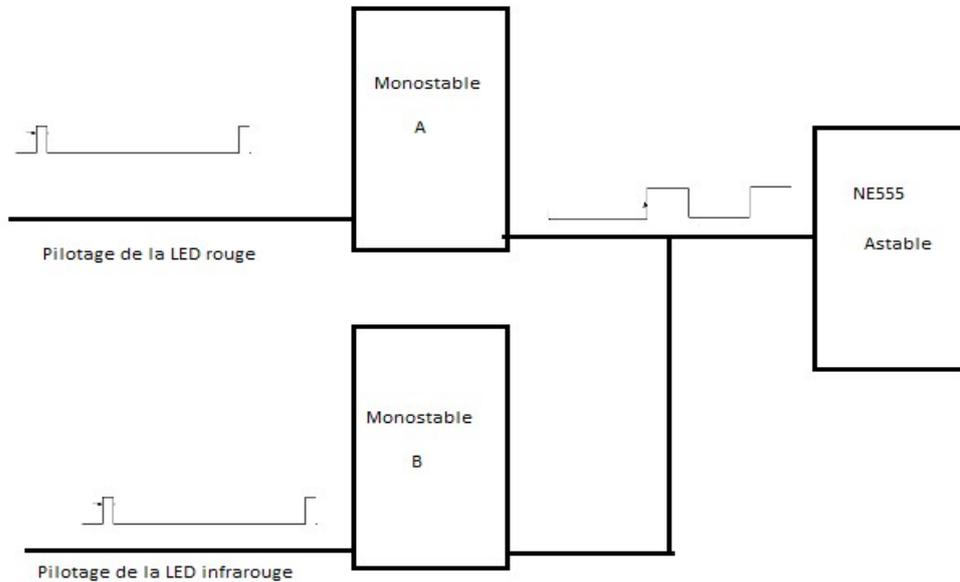
Figure 2.8. Le circuit de pilotage de deux LEDs.
