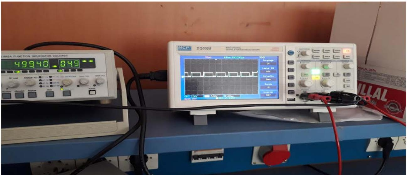
Figure IV. 15 Mesure de cpm et de DDD pour plusieurs fréquences.
