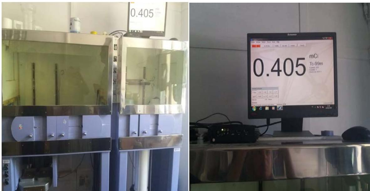
Figure IV. 17 Générateur des radioactifs et l'Activimètre (unité en Curie)
