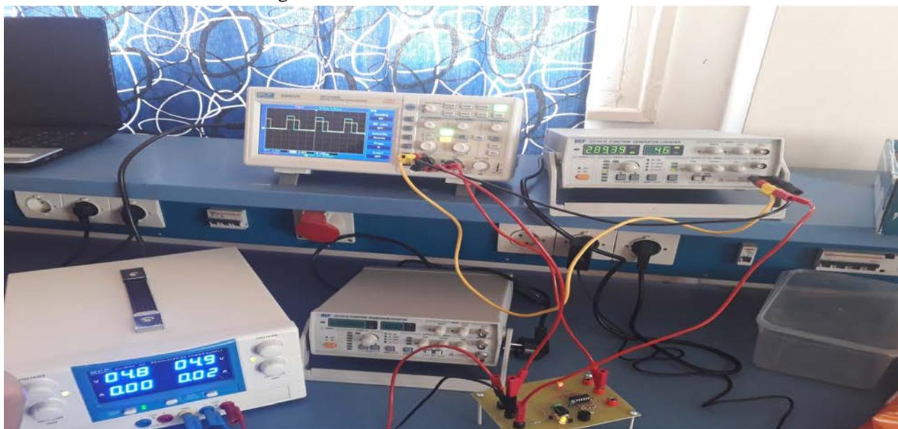
Figure IV. 13 Test de circuit GM avec GBF et Alimentation
