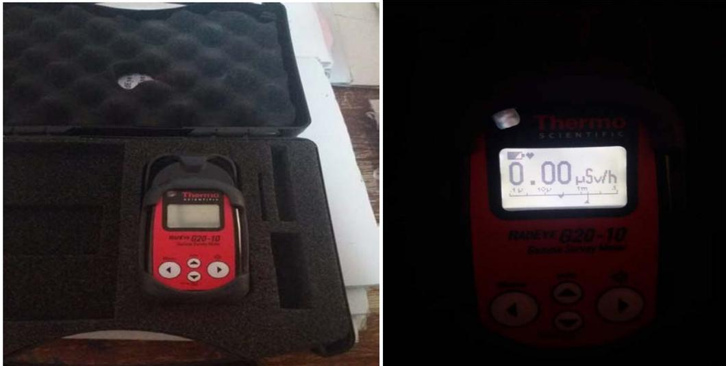
Figure IV. 18 Radiamètre mesurant le DDD (unité en  $\mu\text{Sv/h}$ )
