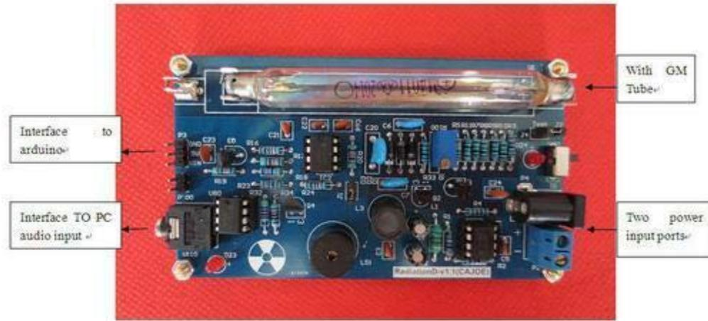
Figure IV. 8 Circuit de conditionnement du tube GM.[73]
