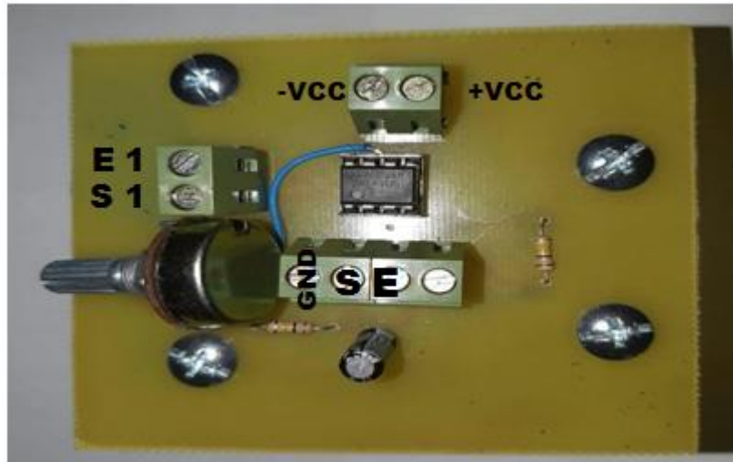
Figure 3.11 : Etage d'amplification et d'offset réalisé
