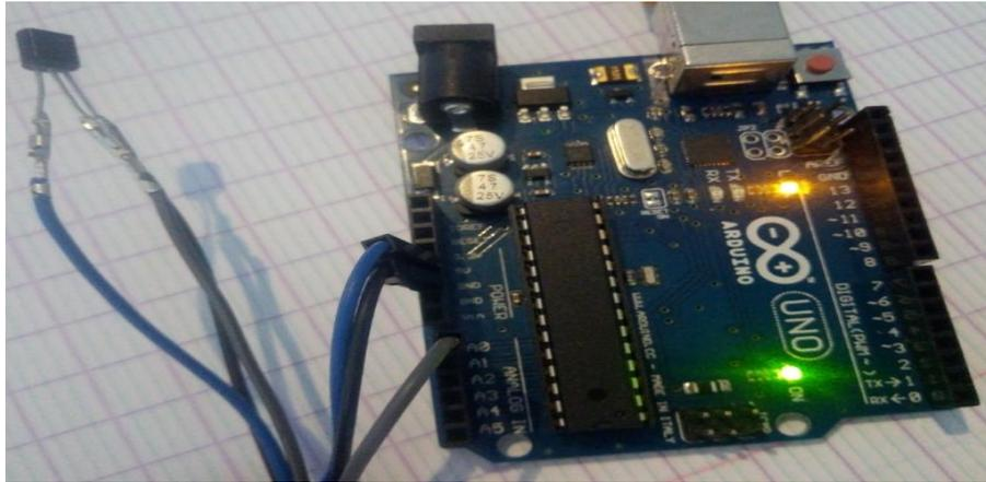
Figure3.12 branchement de LM35 sur la carte Arduino.
