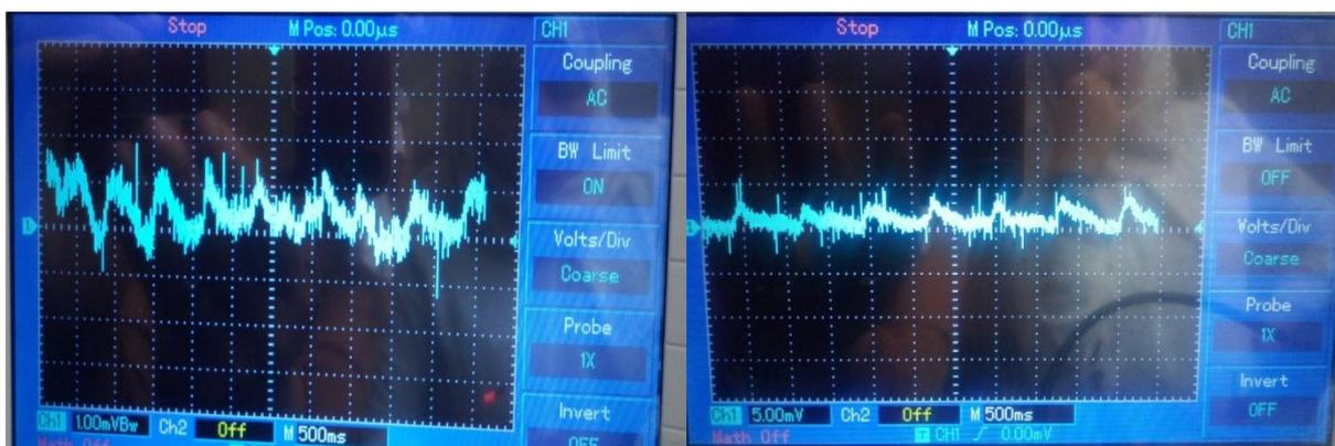
Figure3.17 le signal obtenu a la sortie de capteur (de la LED infrarouge a droite, et de la LED rouge a gauche).
