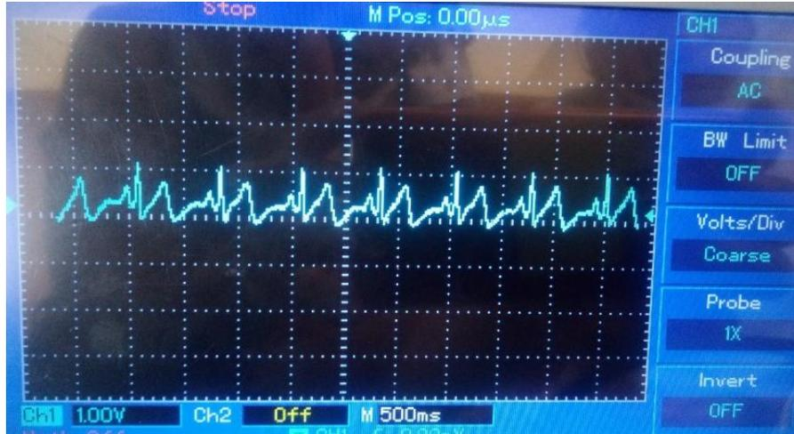
Figure3.11 le signal ECG obtenu à la sortie de filtre réjecteur.
