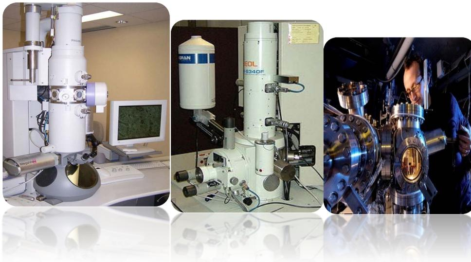
Figure 14 : microscope à transmission, microscope à balayage et microscope à effet tunnel.[10]
