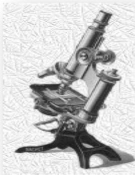
Il s'agit du microscope de base, et il en existe un grand nombre de modèles. Le microscope est composé de différents éléments optiques constitués de lentilles permettant de grossir les sujets à observer. Les préparations sont placées sous l'objectif et éclairées par une source lumineuse pouvant être un miroir ou un système électrique. Les rayons lumineux émis vont agir de différentes façons sur les préparations en fonction de leur source.
