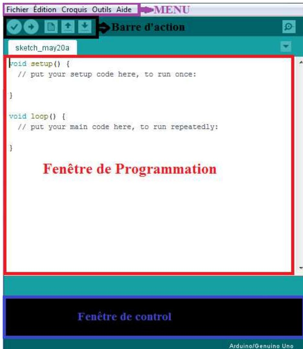
Figure III.7 Logiciel ARDUINO IDE
