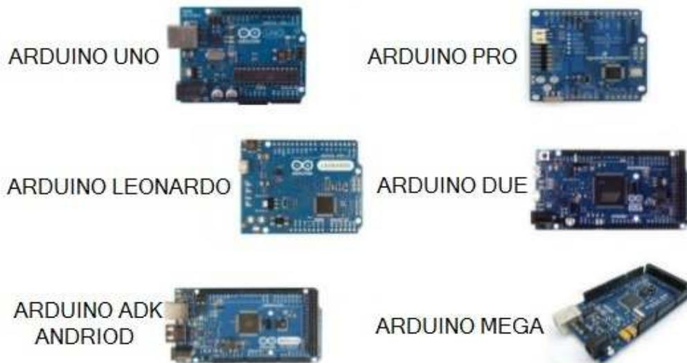
**Figure III.1** Quelques modèles des cartes ARDUINO
