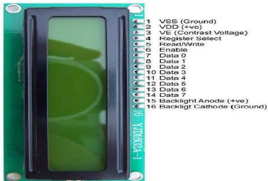
**Figure III.14** Description de L'afficheur LCD 16 x 2
