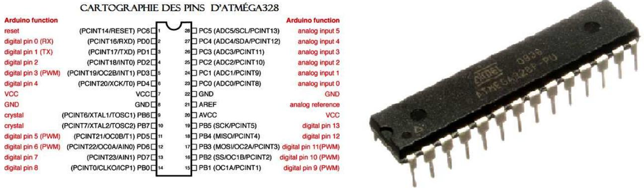
**Figure III.3** Microcontrôleur ATmega328
