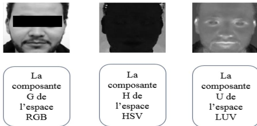
Figure 3.5 - Représentation des composantes G, H et U pour les espaces RGB, HSV et LUV
