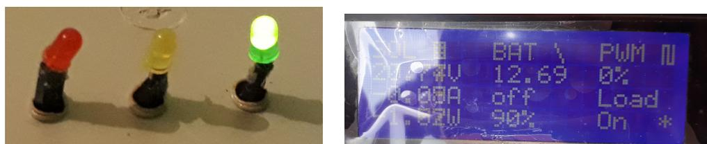
FIGURE III.42 – Informations affichées sur l'écran LCD avec l'indication de la LED vert
