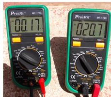
FIGURE III.38 – Tension et courant d'un panneau solaire en charge
