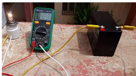
FIGURE III.39 – Circuit de charge avec le courant de charge
