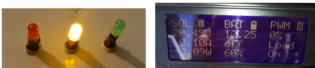
FIGURE III.41 – Informations affichées sur l'écran LCD avec l'indication de la LED jaune
