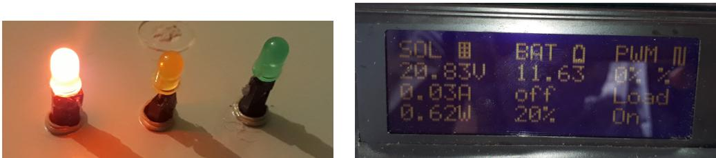
FIGURE III.40 – Informations affichées sur l'écran LCD avec l'indication de la LED rouge
