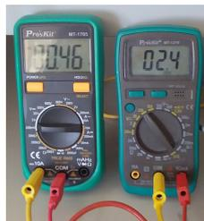
FIGURE III.14 – Mesures relevées sur les appareils de mesure pour  $V_{out}$  et  $I_P$
