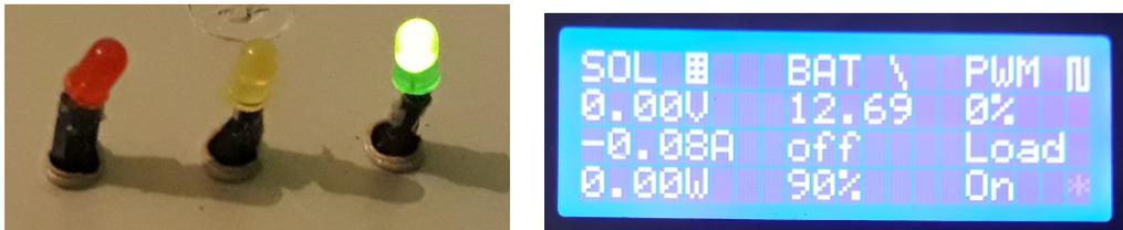
FIGURE III.35 – Informations affichées sur l'écran LCD avec l'indication de la LED vert
