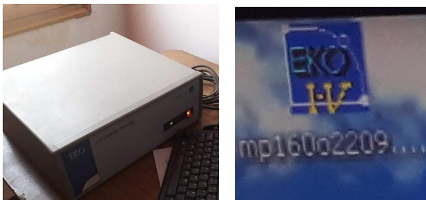
FIGURE III.1 – Traceur de caractéristique de type EKO Instruments MP-160
