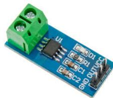
FIGURE II.19 – Capteur de courant ACS712
