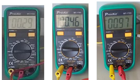
FIGURE III.15 – Trois intensités du courant  $I_p$  affichées par un ampèremètre
