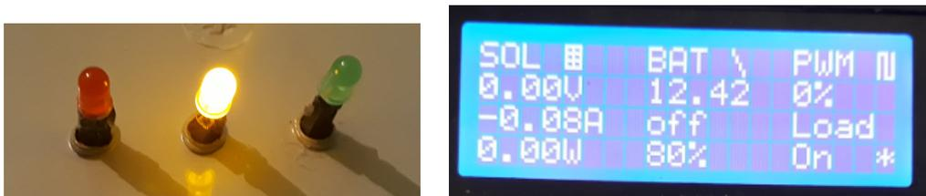
FIGURE III.34 – Informations affichées sur l'écran LCD avec l'indication de la LED jaune
