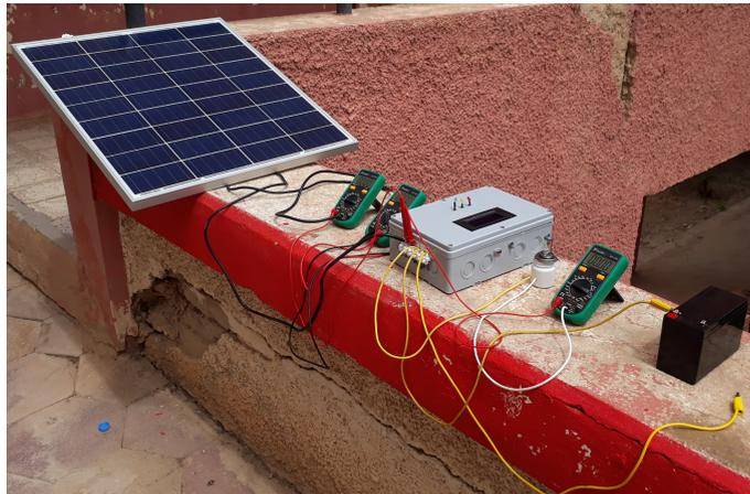
FIGURE III.37 – Circuit réalisé pour allumer la lampe et charger la batterie
