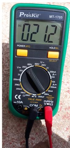
FIGURE III.36 – Tension d'un panneau solaire a vide
