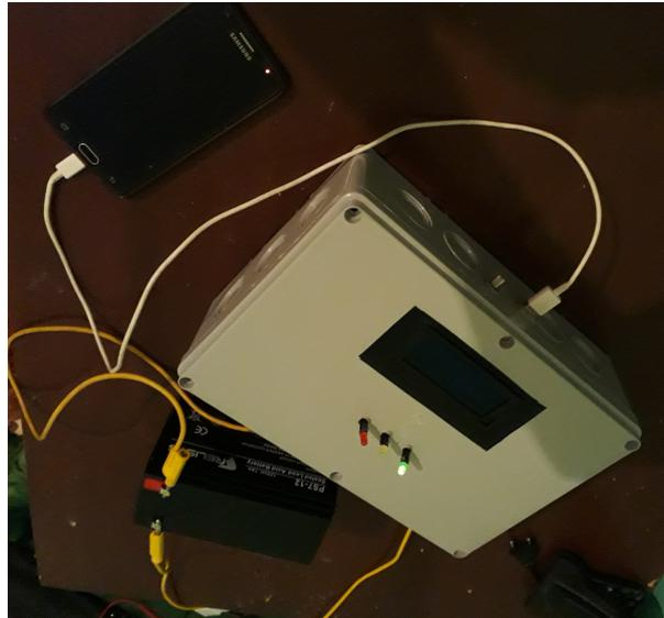
FIGURE III.30 – Circuit réalisé pour charger un téléphone portable
