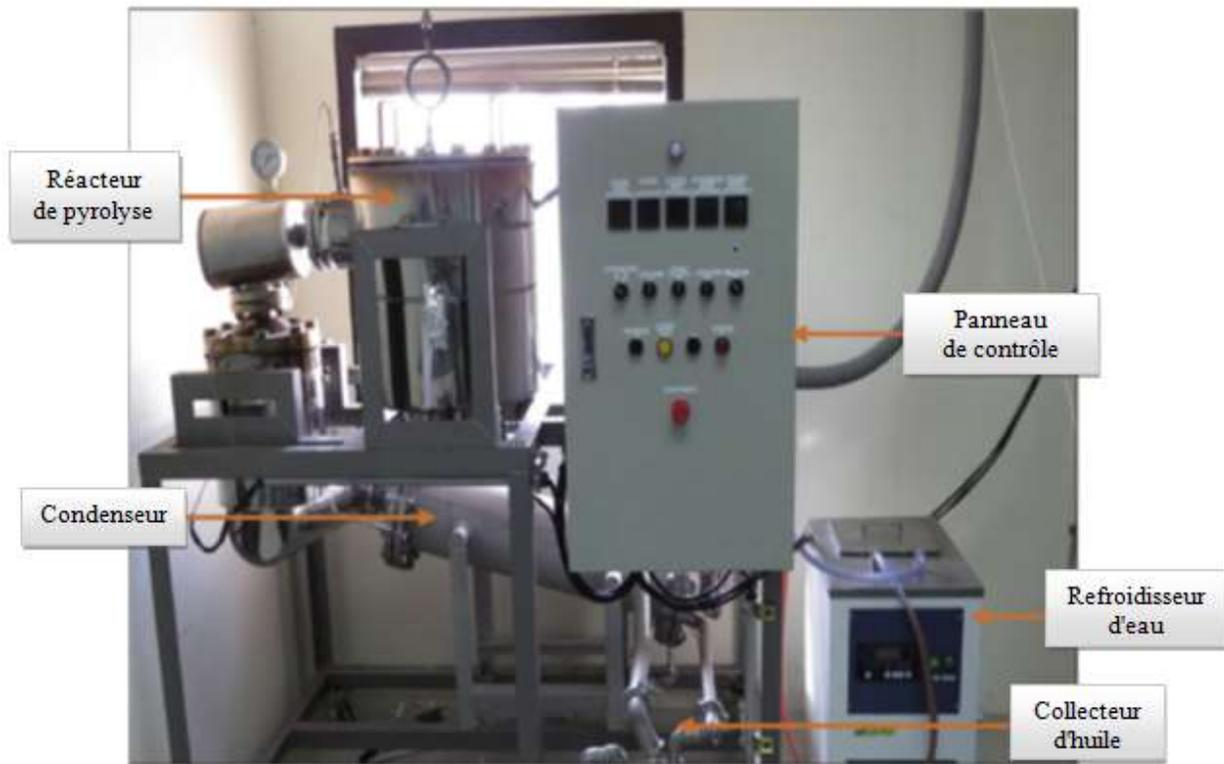
Fig. 4. 2 Prototype d'un système de la pyrolyse du plastique
