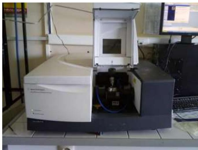
Fig. 4. 19 Appareil FTIR-ATR du Laboratoire de catalyse et synthèse en chimie organique
