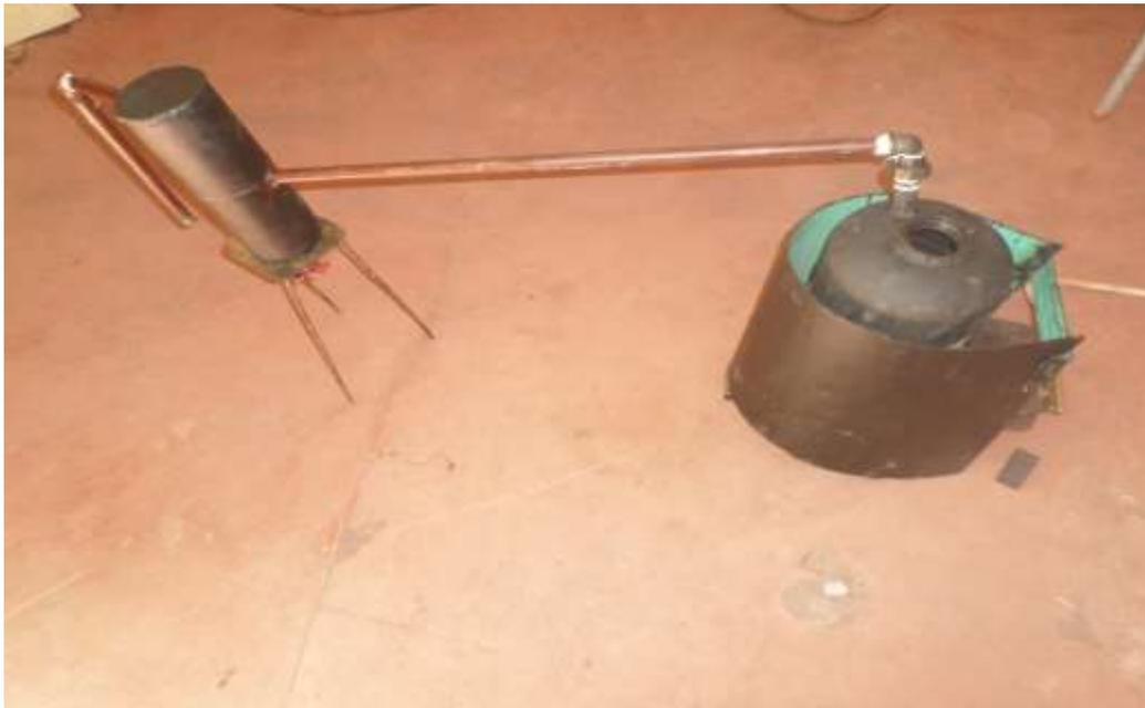
Fig. 4. 12 Procédé de pyrolyse réalisé dans l'atelier
