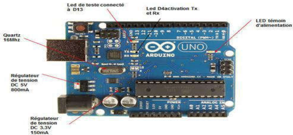
Figure II.25 Brochage interne d'une carte Arduino UNO
