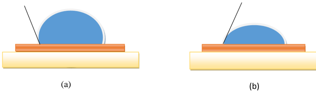
Fig.II.3. L'angle de contact et la mouillabilité des solvants. (a).Surface hydrophobe. (b). Surface hydrophile.
