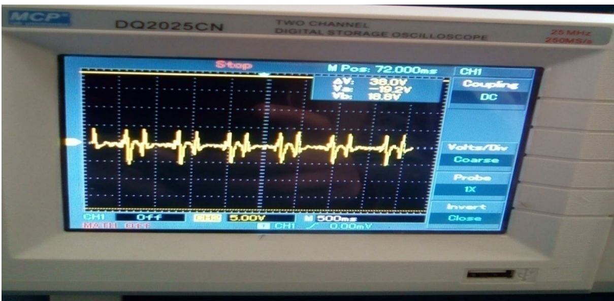
Figure 3.17: signal de sortie d'un amplificateur.
