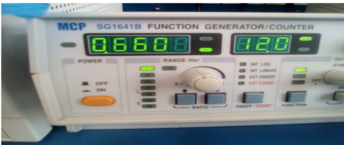
Figure 3.37:Générateur de fréquence affiche 0.66Hz(40bpm).
