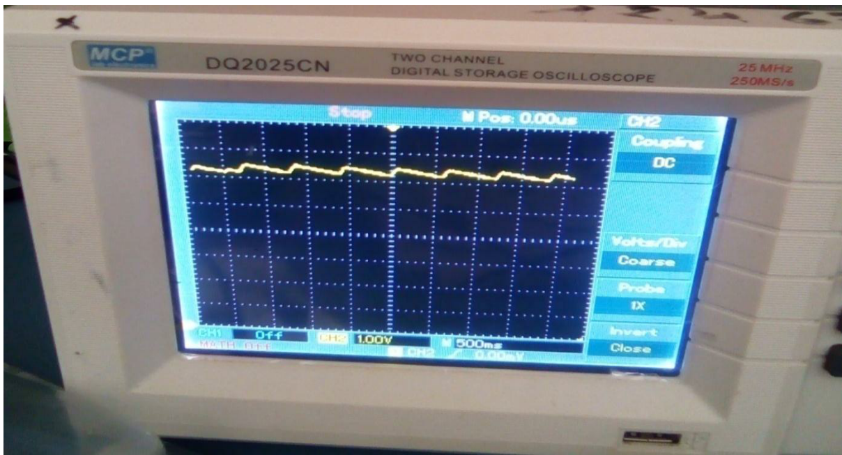
Figure 3.21:le signal de sortie d'un convertisseur fréquence/tension.
