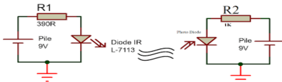
Montage fini d'émission réception par IR.
