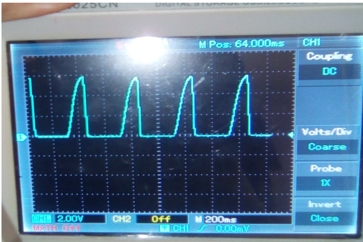
Figure 3.29: le signal après l'impulsion de l'IR avec distance 3cm en absence de lumière ambiante.
