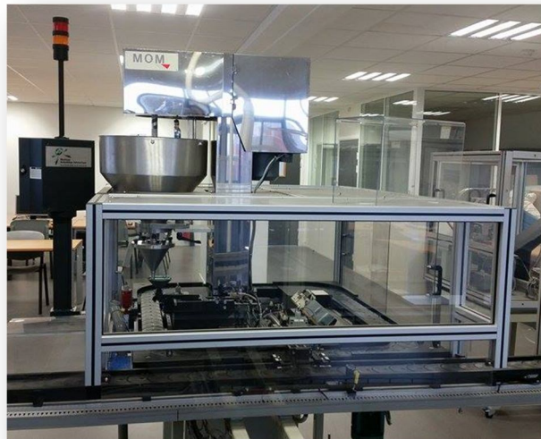
Figure C.4 - Illustration du poste de dosage des granulés
