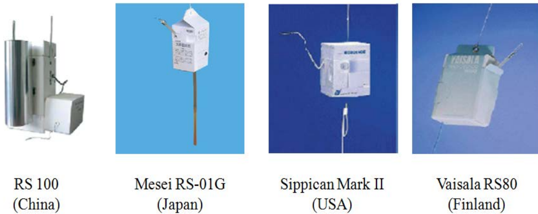
Figure I.9 : Exemples de radiosondes couramment utilisées dans le monde [12]
