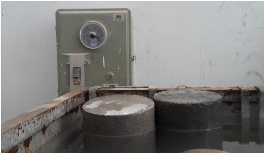
Figure 3.13 : Conservation des éprouvettes (bassin d'eau normalisée)
