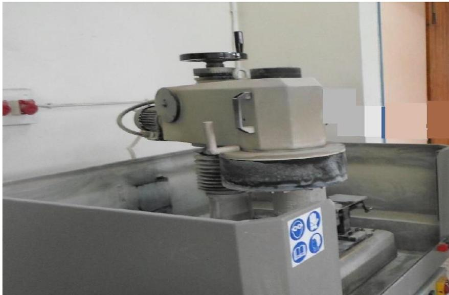
Figure 3.15 : Rectifieuse (surfaçage des éprouvettes)
