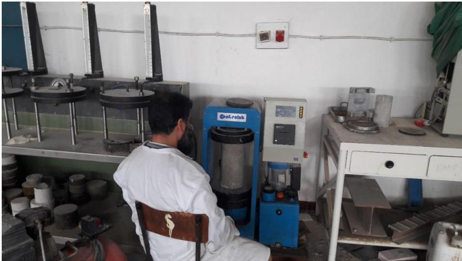
Figure 3.14 : Une presse hydraulique
