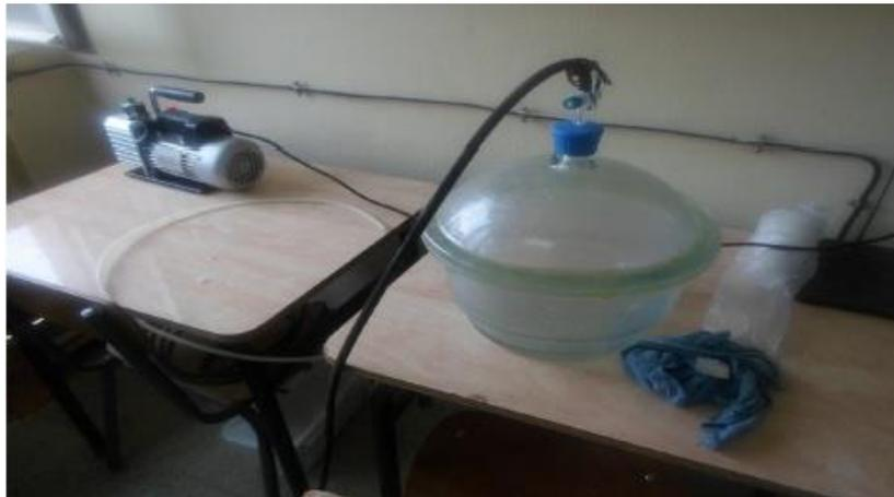
Figure 3. 16 : Dispositif de la porosité accessible à l'eau
