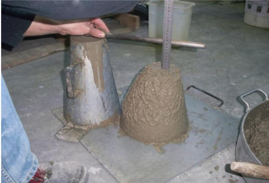
Figure 3. 10 : Essai d'affaissement au Cône d'Abrams sur le béton étudié
