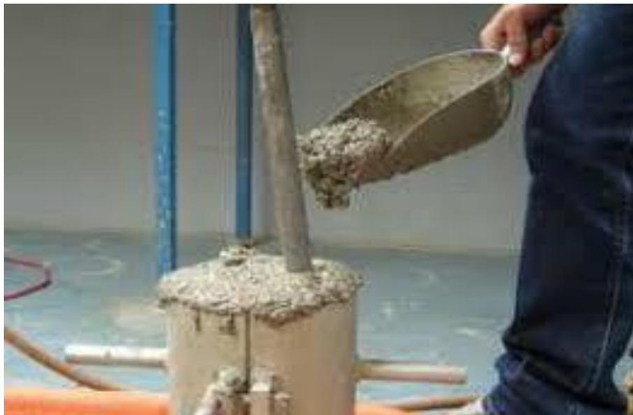
Figure 3.11 : Confection et vibration des éprouvettes  $16 \times 32 \text{ cm}^2$  de béton
