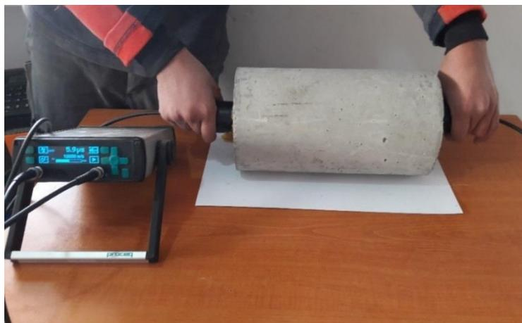
Figure 3.17 : Essai de la vitesse d'impulsion d'ultrason sur une éprouvette de béton
