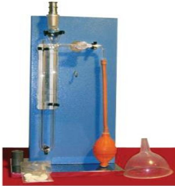
Figure 3.1 : Perméabilimètre de Blaine Manuel
