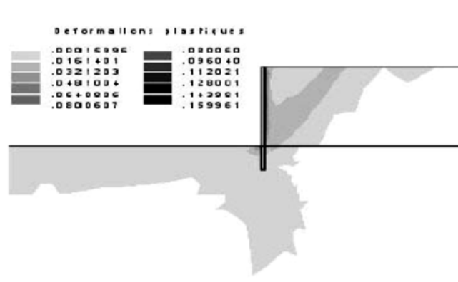
Figure 1.34- Zones en plasticité aux environs de soutènement d'excavation- Delattre (1999)
