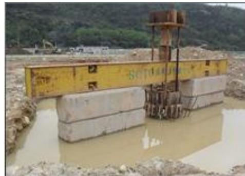
**Figure 1.20:** Essais de chargement statique (compression, arrachement)[2,6]
