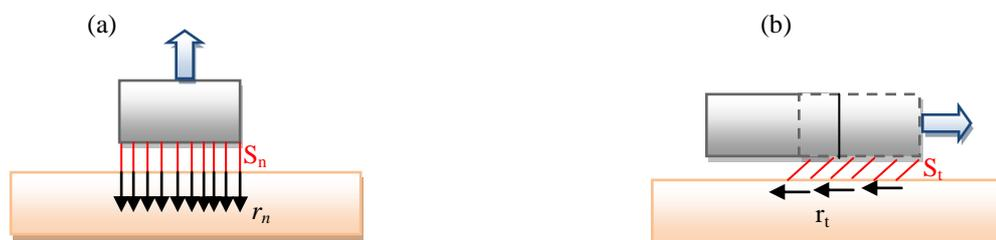
Figure 3.2 : Contact unilatéral avec frottement et adhésion [78]
