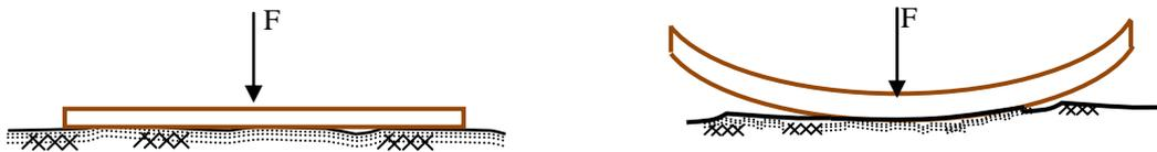
(b) : Interaction poutre-sol déformable chargement
