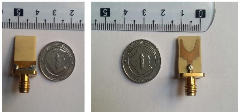
FIGURE 2.23 – Prototype de l'antenne réalisée
