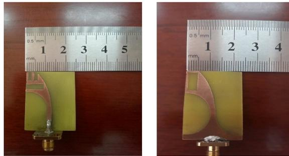
FIGURE 2.40 – Prototype de l'antenne réalisée (vue de Top et Bottom)
