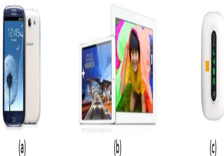
Figure I.25: Exemples des terminaux mobiles: (a) téléphone à écran tactile, (b) tablette, (c) dongle USB 3G [45].
