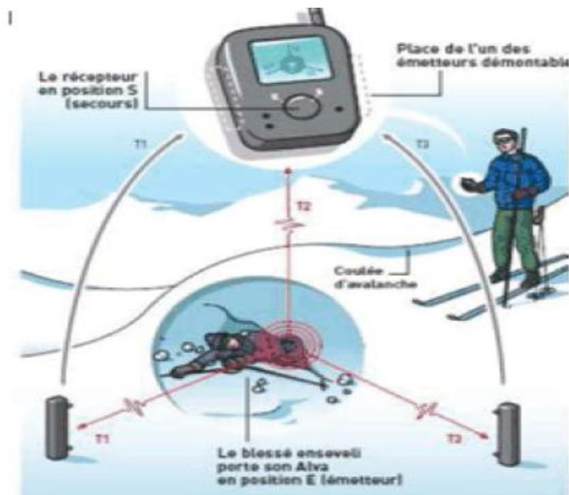
Figure I.38: Exemple des antennes pour la détection de personnes ensevelies sous la neige [57].
